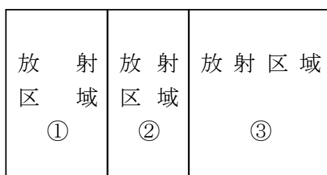
第9-7図 3放射区域のうち隣接する2放射区域の消火剤の最大貯蔵量の例
