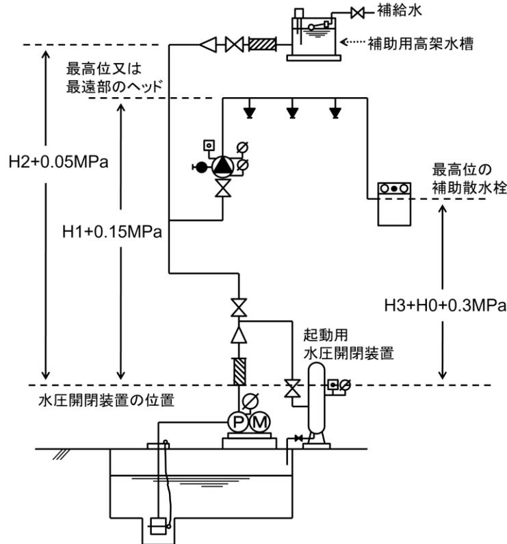
第4-7図 起動用水圧開閉装置により加圧送水装置の起動を行う場合の設定例
