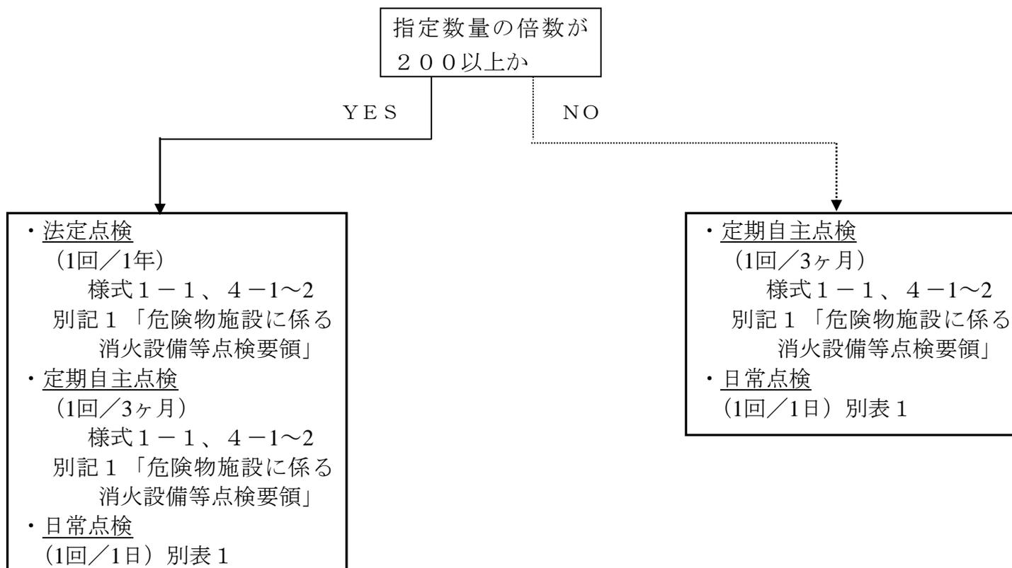
※ 1 内部開放点検及び沈下・水平度測定については、別に定める「堺市危険物屋外タンク貯蔵所の点検基準」によること。
