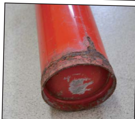
溶接部とその周辺が腐食している
