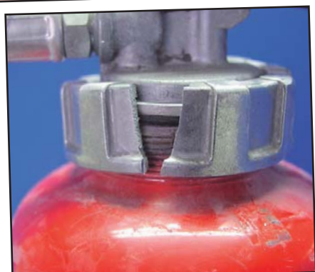
使用に耐えない破損がある
