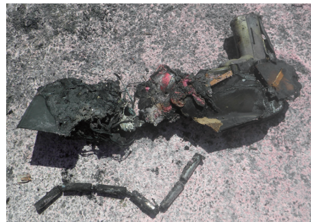
焼損した互換性バッテリー
