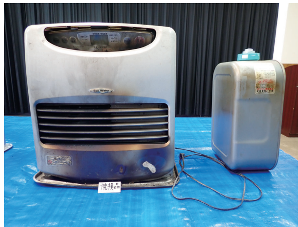
火災が発生した石油ファンヒーター
