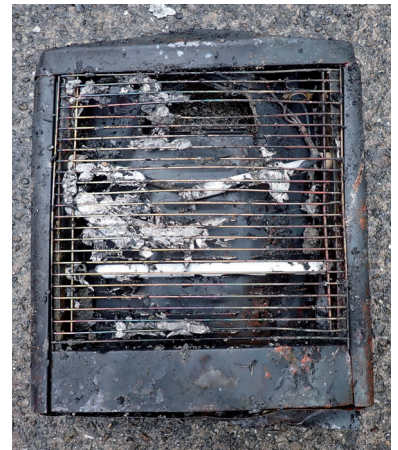
火災が発生した電気ストーブ
