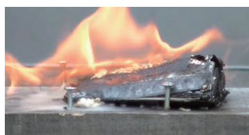
リチウムイオン電池を使用した バッテリーの燃焼実験映像
