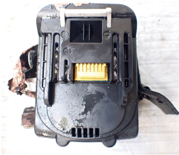
焼損した互換性バッテリー
