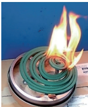
2重巻き状態で激しく燃焼する状況
