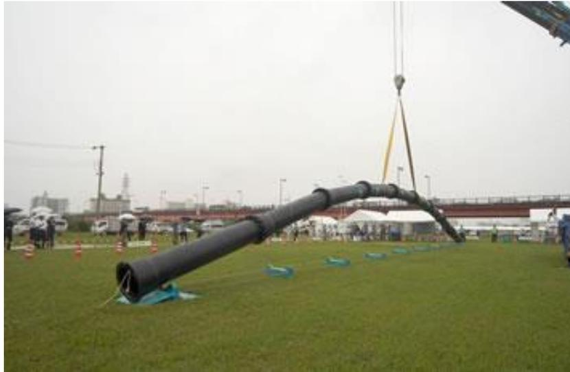
写真: φ500mm 耐震管を吊り下げている様子(日本ダクタイル鉄管協会提供)
