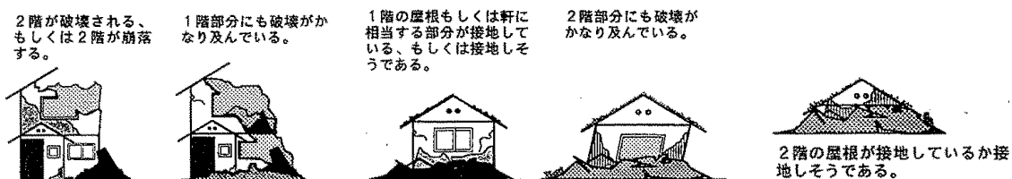
図 3.1-1 層破壊に相当する建物損壊状況〔岡田ほか(1999)より引用〕
