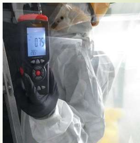
点検口下向きの風速確認
