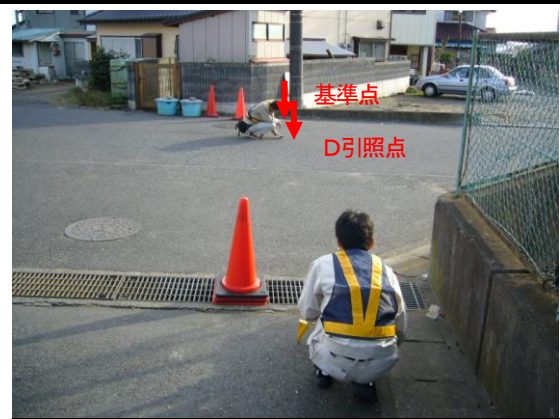
基準点埋設後の点検
