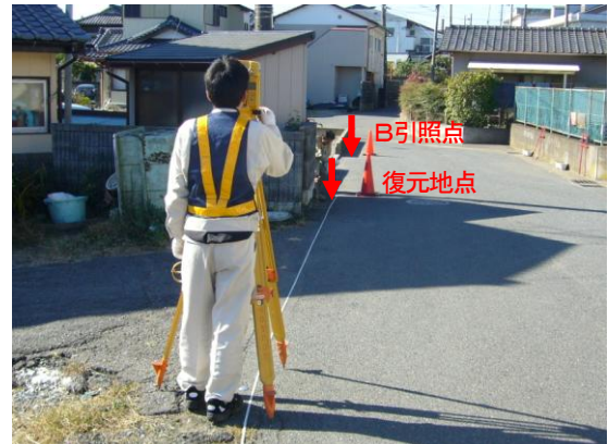
A引照点でのTSによる視準(A引照点～復元地点～B引照点)
