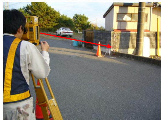
TSによる視準(A引照点～基準点)
