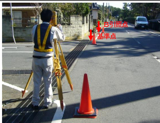
A引照点でのTSによる視準(A引照点～基準点～B引照点)
