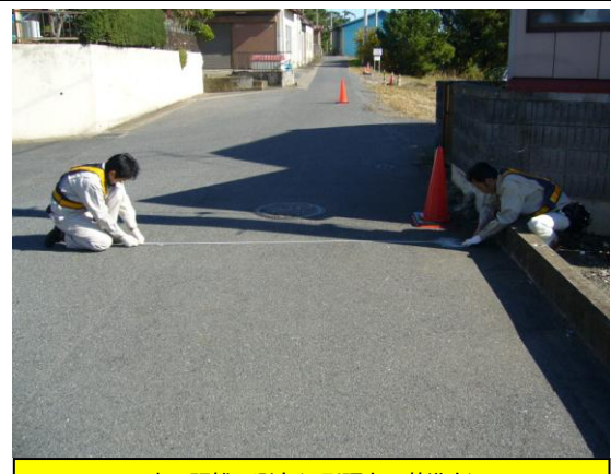
水平距離の測定(D引照点～基準点)
