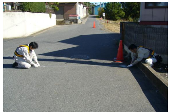
水平距離の測定(D引照点～基準点)
