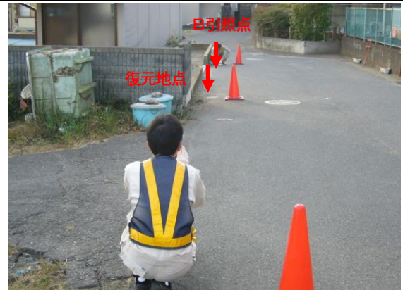
A引照点での基準器による視準(A引照点～復元地点～B引照点)
