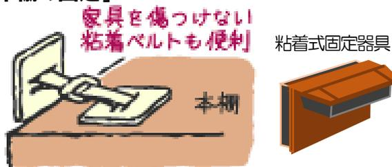
タンスと同じように、壁の中の硬い所があるとところにポール式器具を取りつけます。また、壁に穴をあけないタイプの粘着式の固定器具もあります。
