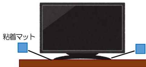
テレビとテレビ台の間に設置するタイプのもので振動を吸収する力により、転倒を防止します。
