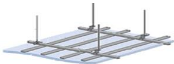
吊り天井の構造
