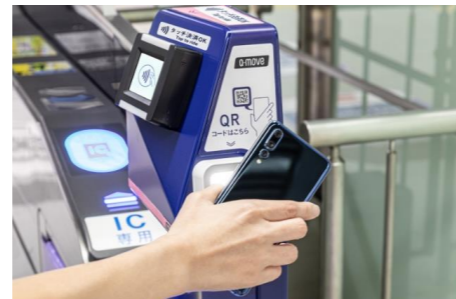
タッチ決済用とQRコードリーダーを搭載した改札機
