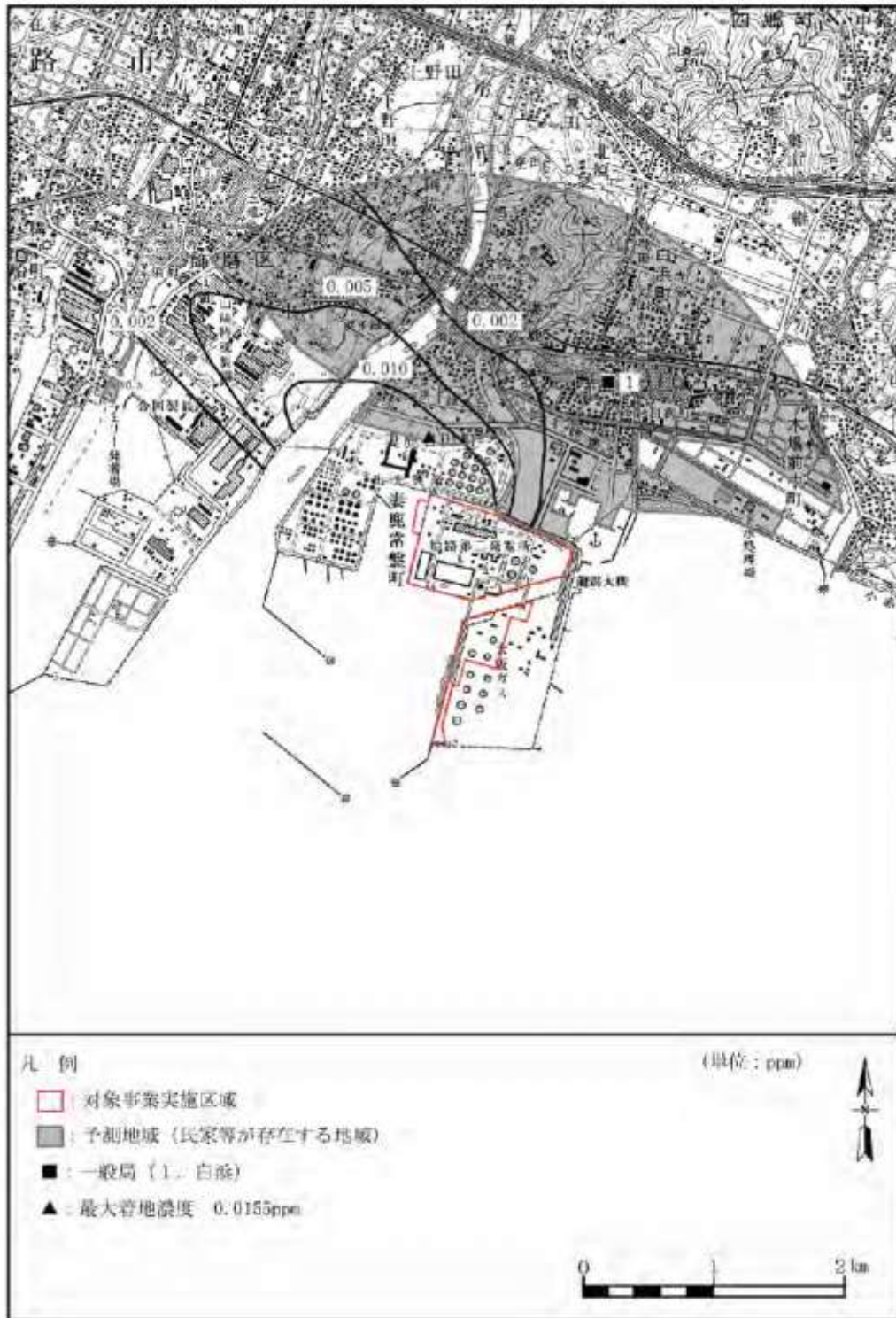
第 8.1.1.1-27 図 建設機械等の稼働による二酸化窒素濃度の予測結果
