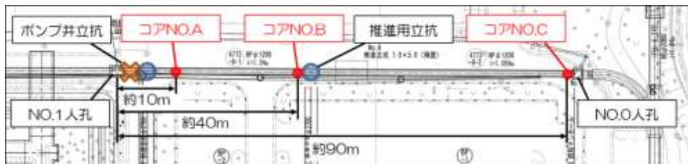
図5-4 管厚測定箇所
