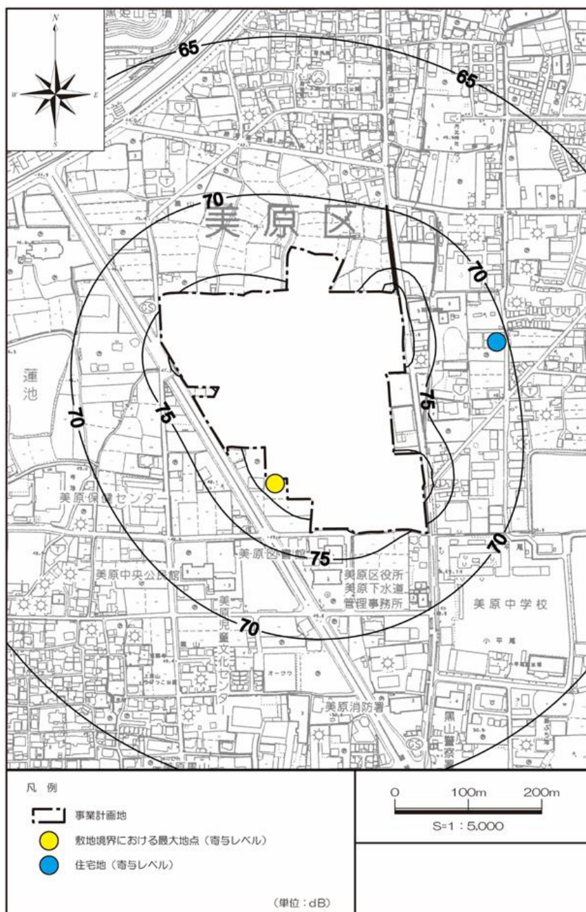
図Ⅱ-3-4-5 建設機械の稼働に伴う騒音レベル予測結果（工事開始後20ヶ月目）
