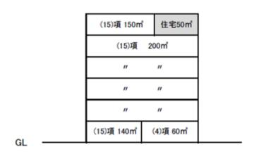
この場合、(4)項、(15)項、一般住宅の複合用途防火対象物であるが、(15)項部分の床面積の合計が当該防火対象物の延べ面積の90%以上であり、(4)項及び一般住宅部分の床面積の合計が300㎡未満であるので、政令別表第1(15)項の防火対象物として取り扱う。
