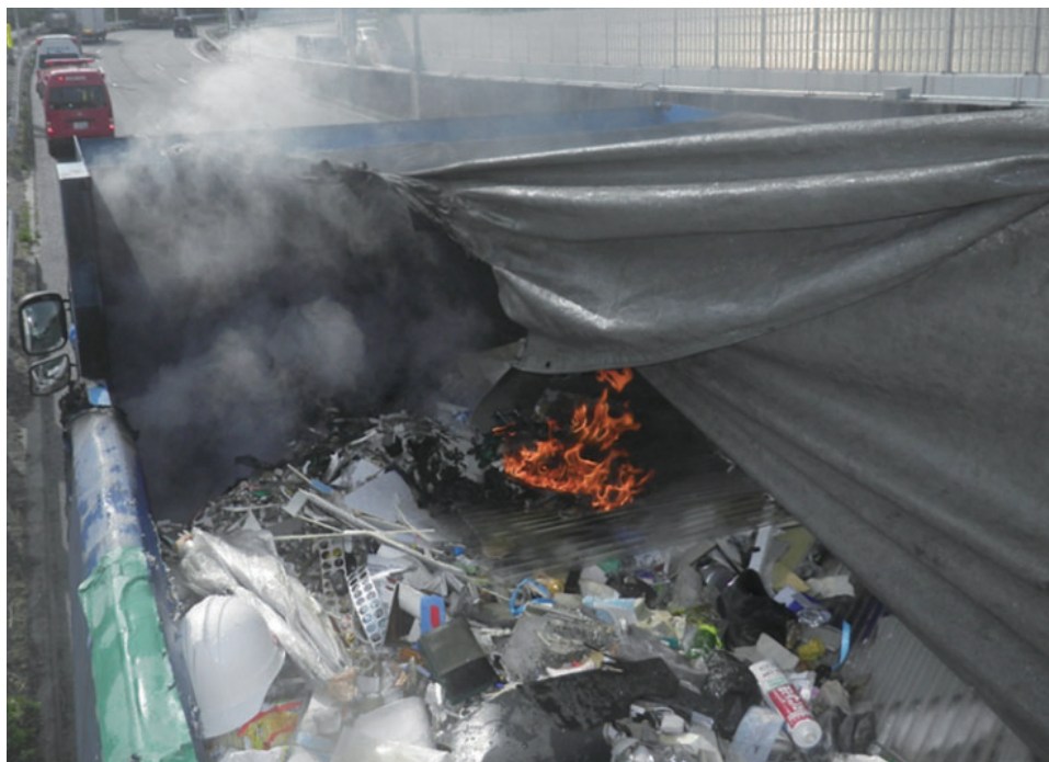
ゴミ収集車内でバッテリーから他の廃棄物に燃え移っています。
