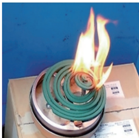
2重巻き状態で激しく燃焼する状況
