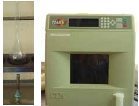
図 2. ケルダール分解の様子(左)とマイクロウェーブ装置(右)
